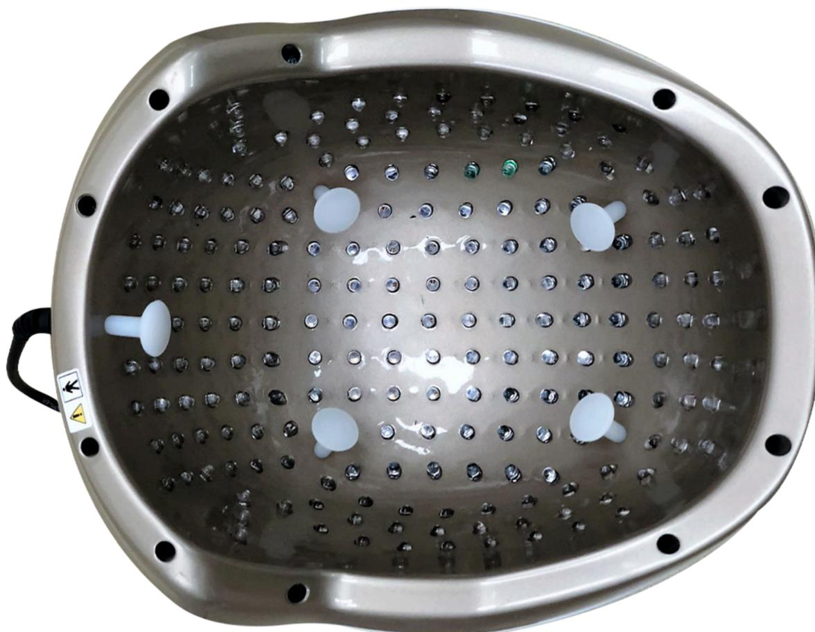
Os espaçadores de silicone devem ser inseridos no interior do capacete conforme ilustra a figura acima. Há cinco espaços destinados ao encaixe destes espaçadores. Esses espaços estão distribuídos na parte superior (4 espaços) e na parte de traz do capacete (1 espaço). O uso dos espaçadores é facultativo pelo médico.
